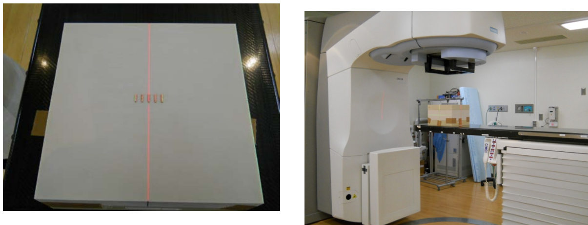
Fig 3. 照射時の様子(左：素子の配置 右：リニアックとファントムの配置)
