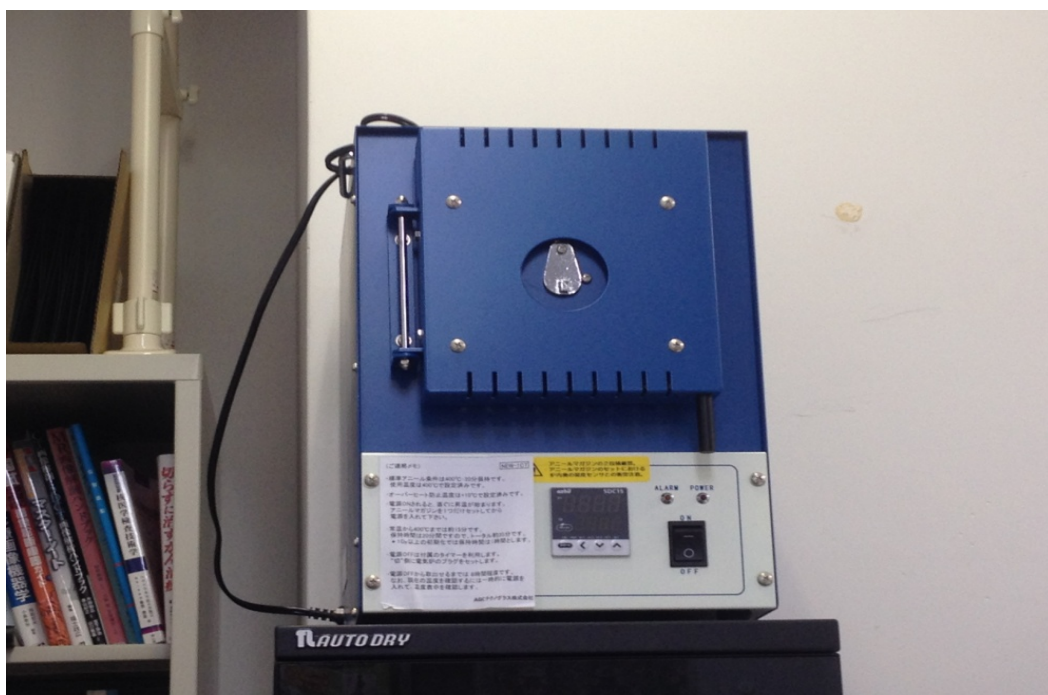
Fig.2 アニール用電気炉：NEW-1CT
