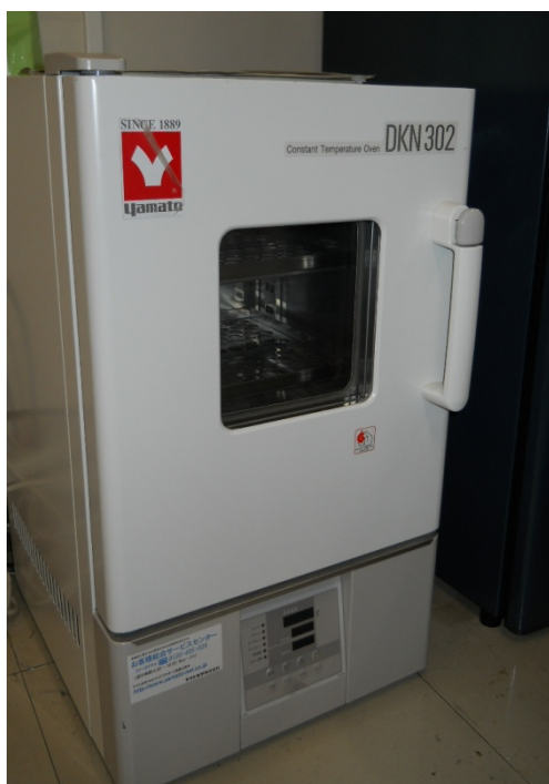
Fig.3 プレヒート用恒温器 : DKN-302
