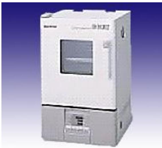
Fig. 7 ガラスプレヒート用恒温器 DKN-302
