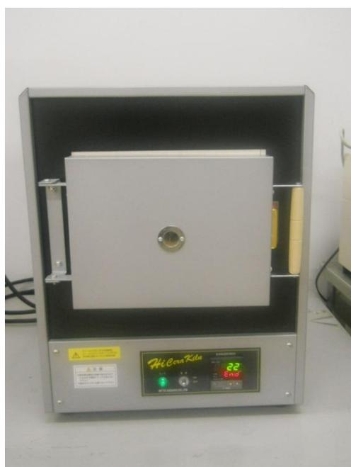
Fig. 5 ガラスアニール用電気炉 NHK-210
