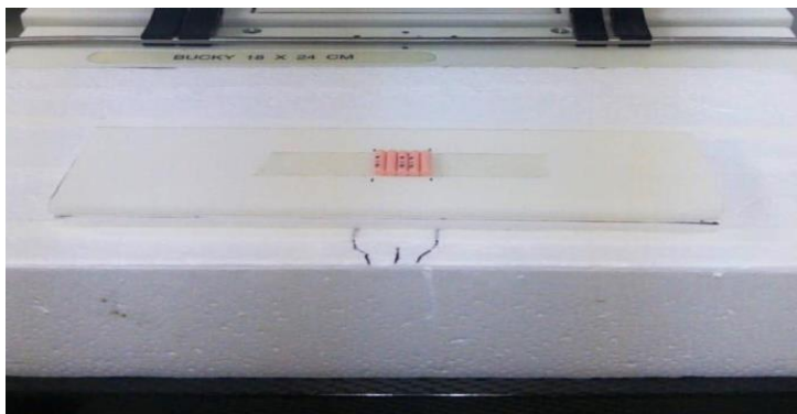
図 8 空気カーマ測定時の外観(GD)
